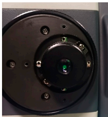
Рис. 2. Устройство системы крепления сетки нитей у тахеометра EFT TS1 Примечание: составлен авторами по результатам данного исследования
