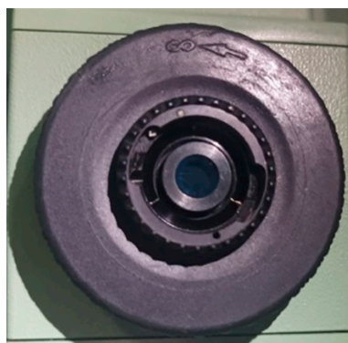
Рис. 4. Устройство сетки нитей прибора Leica TS06 Примечание: составлен авторами по результатам данного исследования
