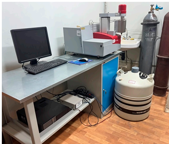
Рис. 1. Дифференциально-сканирующий калориметр Setaram Sensys Evo TG-DSC Примечание: составлен авторами по результатам данного исследования
