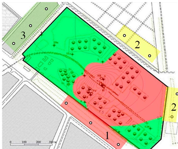
Рис. 1. Эколого-гидрогеохимическая аномалия на нефтебазе и схема отбора проб на участках с высоким (1), средним (2) и низким (3) загрязнением почвы
