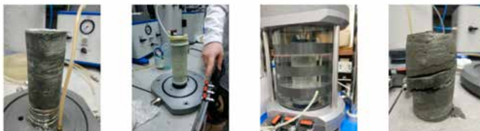
Рис. 4. Образец грунта в процессе испытания на трехосное сжатие
