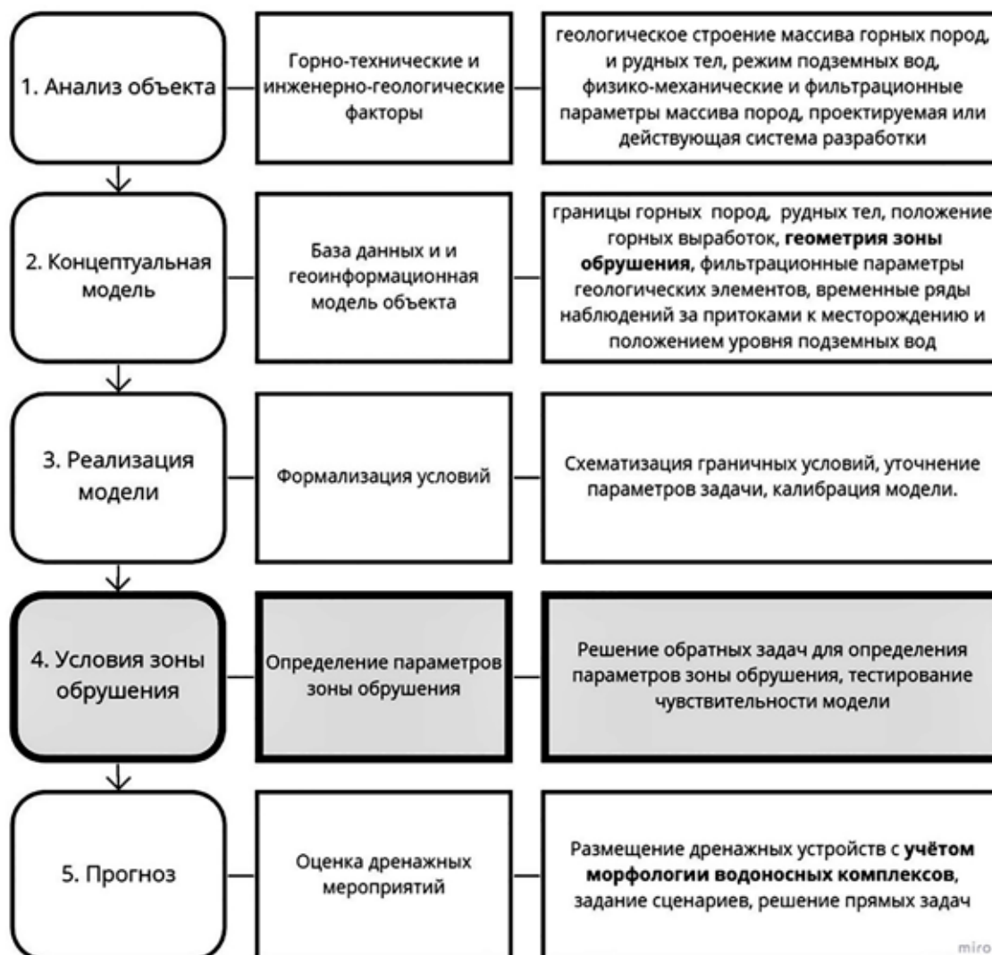
Рис. 6. Методика обоснования дренажа дезинтегрированного массива зоны обрушения
