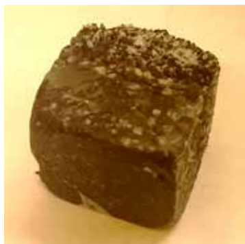
Рис. 3. Образец льдопородной закладки \mu_{\text{воды}} = 30\% с отчетливой границей водонасыщения/недостаток льда-цемента
