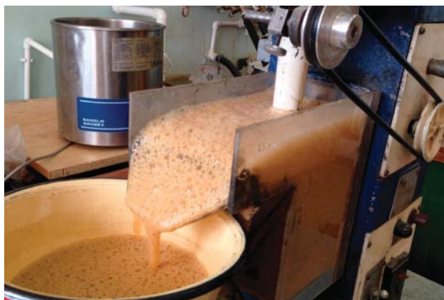
Рис. 2. Процесс работы на флотационной машине ФЛ 240-А
