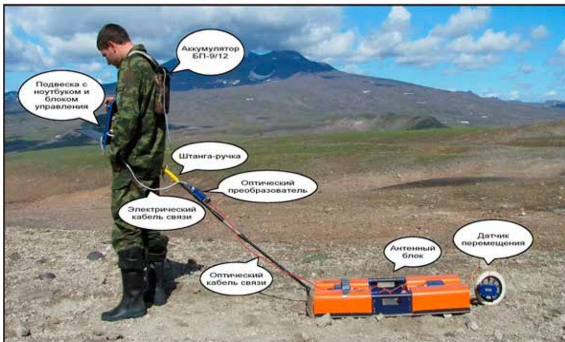
Рис. 2. Оператор с прибором георадар «ОКО-250»
