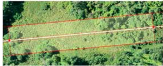
Рис. 3. Определение точных границ охранной зоны участка линии электропередач при аэрофотосъемке с БВС
