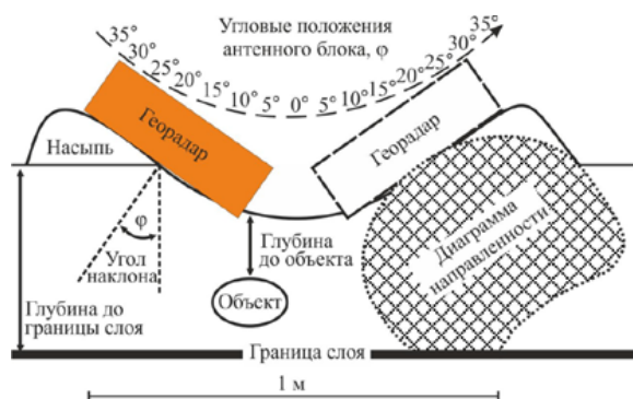
Рис. 2. Угловое георадиолокационное сканирование: а) схема выполнения углового георадиолокационного сканирования; б) доработанный антенный блок георадара «ОКО-2»
