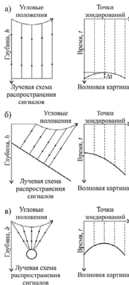
Рис. 3. Схемы формирования волновой картины для различных геологических разрезов при угловым георадиолокационным сканированием: а) горизонтально-слоистый разрез, б) наклонно-слоистый разрез, в) однородный разрез с включением локального объекта
