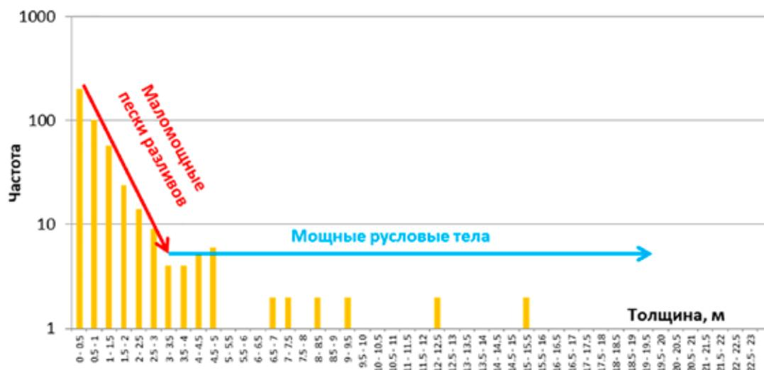
Рис. 7. Гистограмма распределения толщин блока макрофаций песчаных аллювиальных отложений для интервала мальшевского горизонта с выделением по ней самостоятельных мощных трендов макрофаций русел и песков разлива
