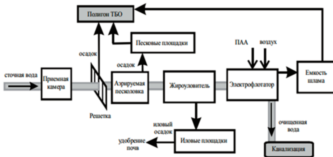
Рис. 1. Типовая схема очистных сооружений мясоперерабатывающих предприятий
