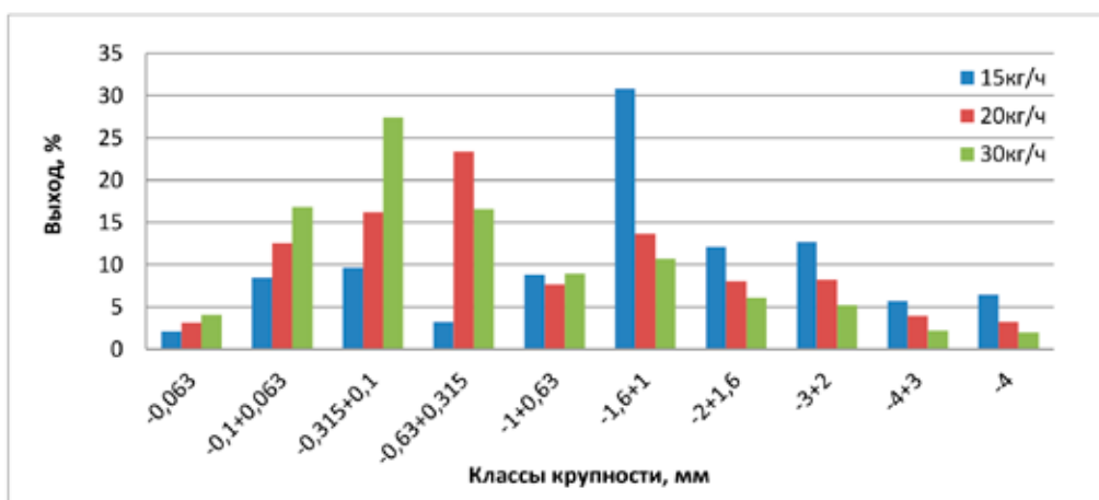
Рис. 2. Динамика изменения гранулометрического состава продуктов измельчения в зависимости от производительности лабораторного образца конусной мельницы
