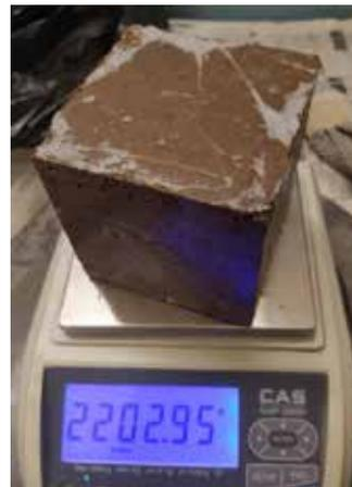
Рис. 1. Взвешивание образца после распалубки металлической кассеты
