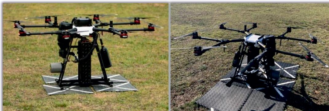
Рис. 5. Высевающий комплекс компании AirSeed Technologies
