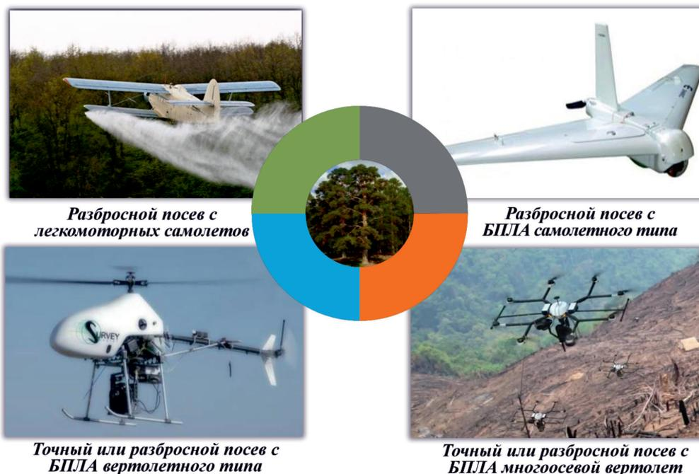
Рис. 1. Летательные аппараты, применяемые для аэросева и имеющие перспективы подобного применения
