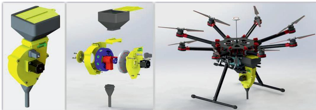
Рис. 7. Пневматический высевательный комплекс точного посева проекта Smart Forest
