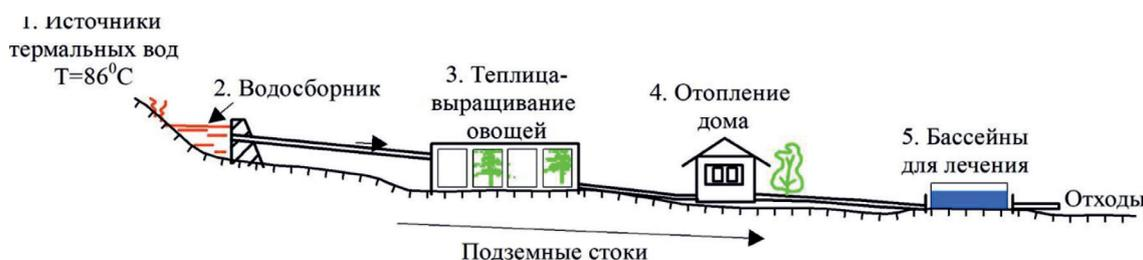
Рис. 2. Схема комплексного использования термальных вод на курорте «Цэнхэр»
