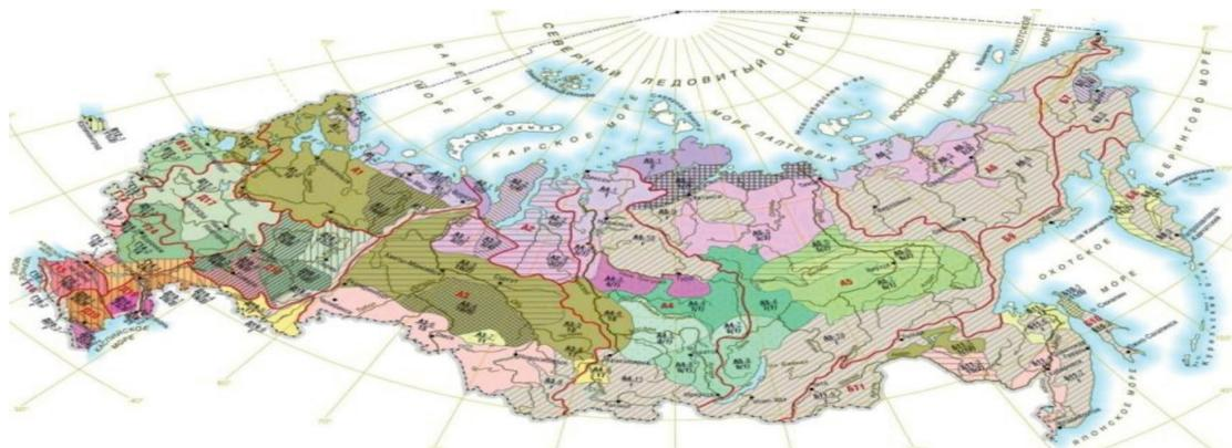
Рис. 1. Прогнозное ландшафтно-геохимическое районирование по типам изменений природной среды при добыче и транспортировке нефти
