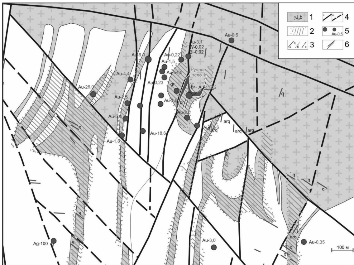
Рис. 1. Схема геологического строения участка: 1 – граниты Басугуньинского комплекса; 2 – зоны березитизации пород; 3 – кварцевые (q), сульфид-кварцевые (sq), арсенопирит-кварцевые (arq) жилы (a), прожилковые зоны (б), минерализованные зоны дробления (в); 4 – разломы достоверные (a), предполагаемые (б); 5 – Рудопроявления и пункты минерализации, содержания золота; б – рудные тела
