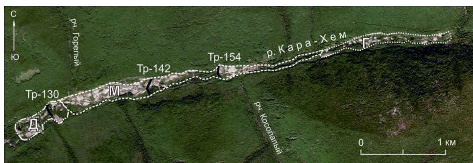
Рис. 1. Техногенная россыпь Кара-Хем: Д – участок дражной отработки, М – участок мускульной отработки, Г – участок гидравлической отработки россыпи. Тр-130 – разведочные траншеи и их номера
