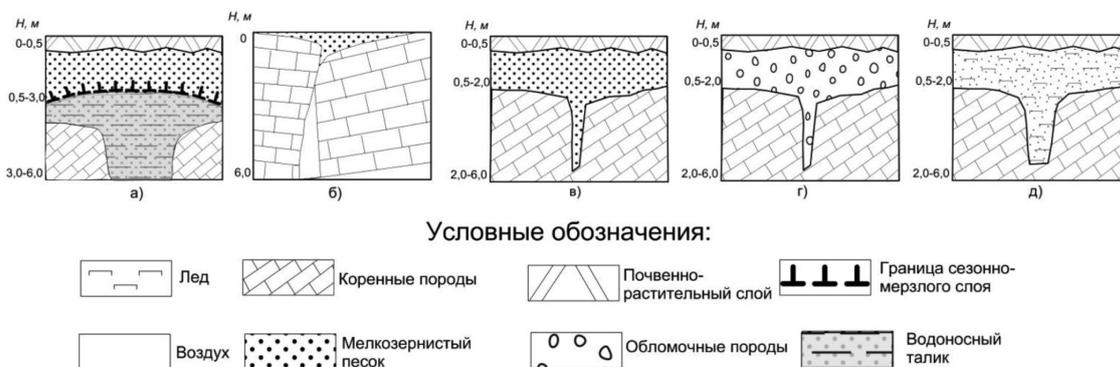
Рис. 2. Модели разрезов, образованных в результате морозобойного растрескивания массива горных пород криолитозоны
