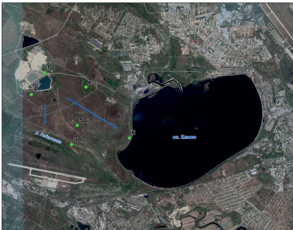
Местоположение объектов исследования: 1 – гидрозолоотвал; 2 – разгрузка; 3 – скважина в долине р. Кадалинки; 4 – скважина 241; 5 – скв. 26 кн; 6 – скв. 24 кн. Стрелками показано направление движения вод
