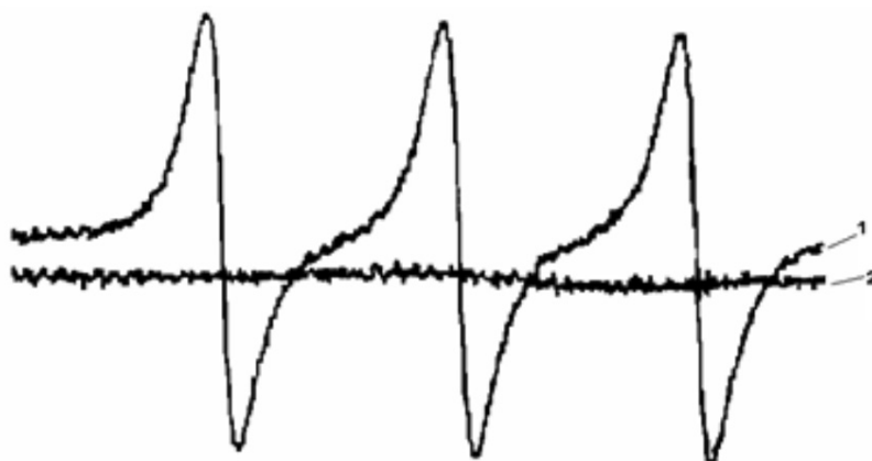
Рис. 4. ЭПР-спектры: 1 – эталон ТЕМПО (2,2,6,6-тетраметил-4-оксопиперидин-1-оксидом); 2 – \text{Na} -нафталиновый комплекс, полученный с использованием отходов в ТГФ
