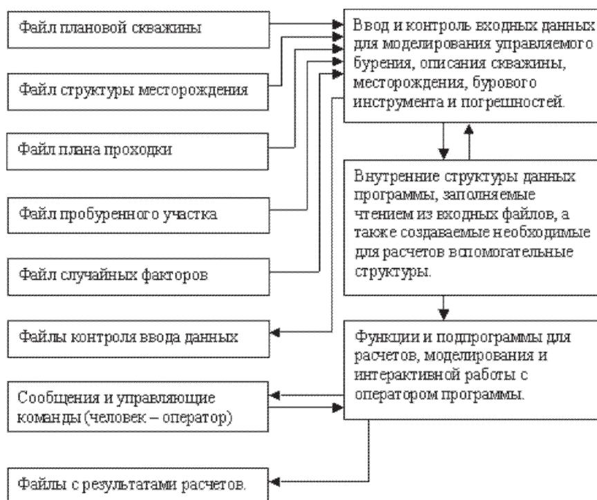
Рис. 1. Блок-схема компьютерной программы имитации управляемого бурения
