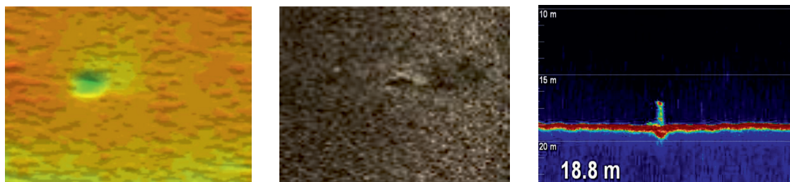
Рис. 1. Изображение, полученное МЛЭ (слева), ГБО (в центре) и узколучевым эхолотом (справа), торчащей из дна обсадной трубы заглушенной скважины
