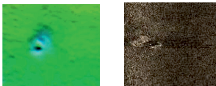
Рис. 2. Изображение нескольких техногенных объектов на дне, полученное МЛЭ (слева) и ГБО (справа)
