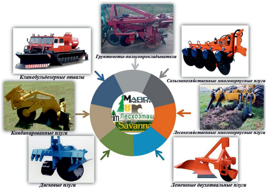
Рис. 2. Основные виды техники и орудий, используемых при создании минерализованных противопожарных лесных полос
