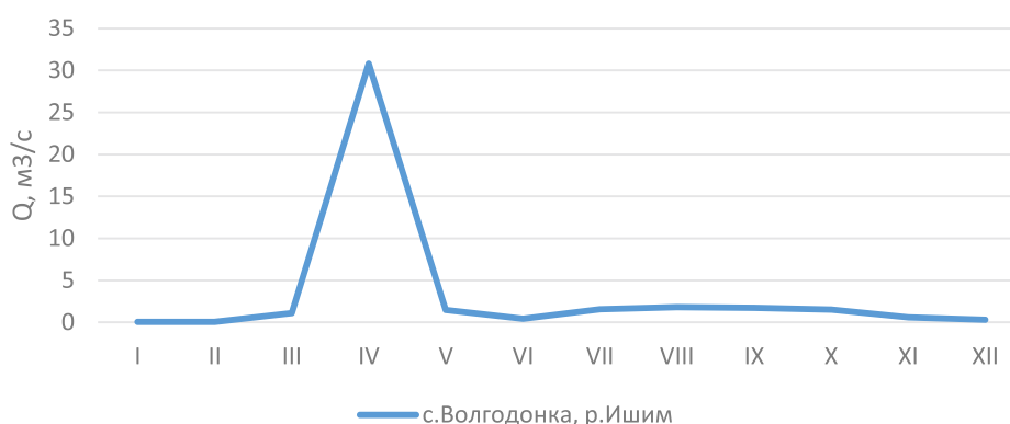
Рис. 3. Гидрограф стока за 2014 г., построенный по средним месячным значениям
