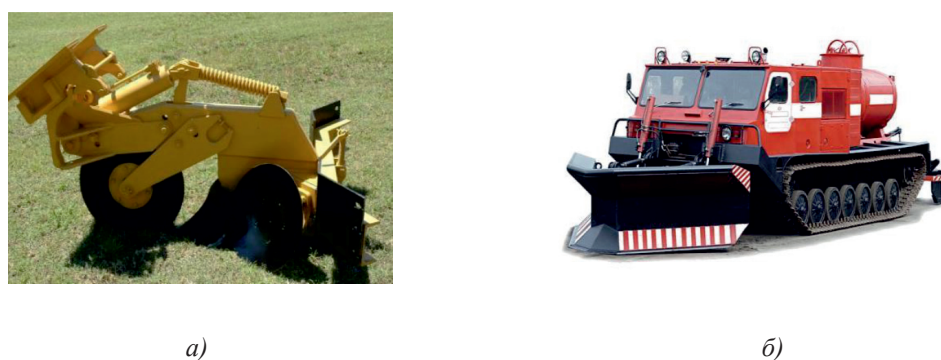
Рис. 4. Образцы лесного комбинированного плуга (а) и клинобульдозерного отвала (б)
