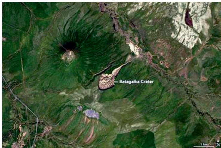
Рис. 1. Термокарстовый провал – кратер Батагайка (Республика Саха; около 100 м в глубину и один километр в длину, по краям оползни; образовался после сведения леса в 1960-х гг., приведшего к наводнению; увеличивается каждый день, из-за таяния вечной мерзлоты) [6]
