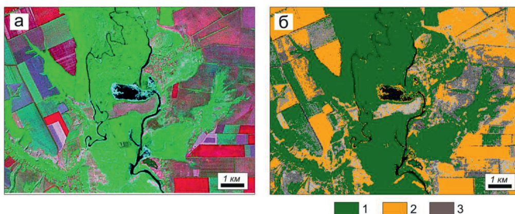
Рис. 2. Использование алгоритма неконтролируемой классификации ISODATA (б) для анализа мозаичного снимка Landsat (каналы 7-4-2, состояние местности 1999–2002 гг.) (а). Интерпретация: 1 – площади здоровой вегетации; 2 – сельскохозяйственные угодья, 3 – области нарушенной растительности, являющиеся местами сноса глинистого материала, приводящие к заилению
