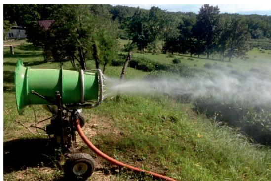
Рис. 1. Снегогенератор (снежная пушка) модель ESG-305 в работе
