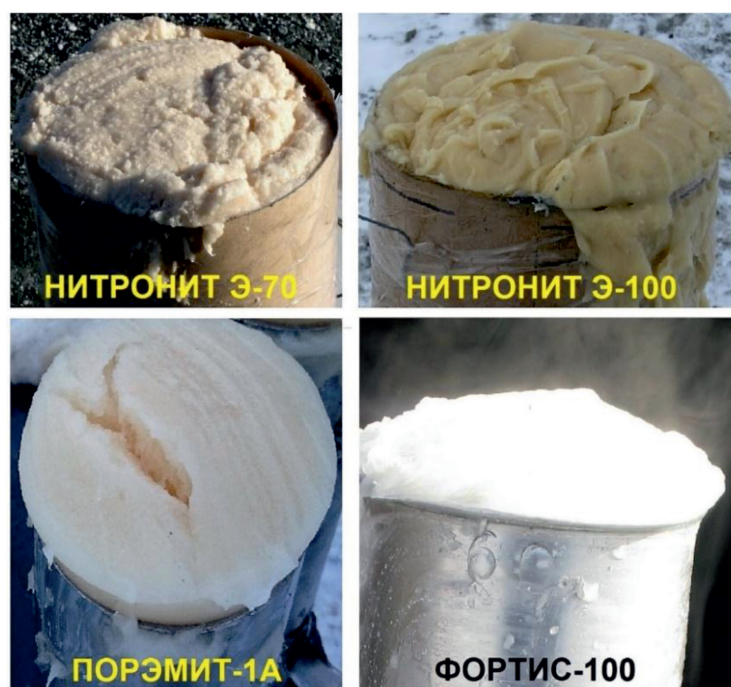
Рис. 1. Исследуемые эмульсионные взрывчатые вещества, применяемые на карьерах Урала
