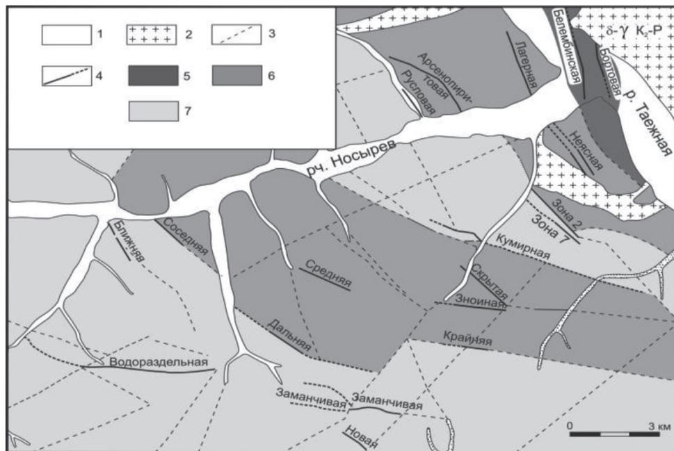
Рис. 3. Зональное размещение многометалльной рудной минерализации в пределах Кумирного месторождения. 1 – четвертичные отложения; 2 – Малиновский гранитоидный массив (δ-γ К<sub>2</sub>-Р); 3 – тектонические нарушения; 4 – рудные тела; 5–7 – геохимические типы руд: 5 – олово-медно-серебряный (Sn-Cu-Ag); 6 – полиметалльно-серебряный (Zn-Pb-Ag); 7 – золото-серебряный (Au-Ag)
