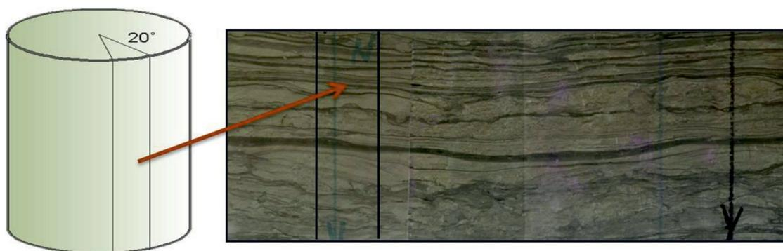
Рис. 2. Схема построения круговой развертки керна на 360 градусов, N – направление керна на палеосевер
