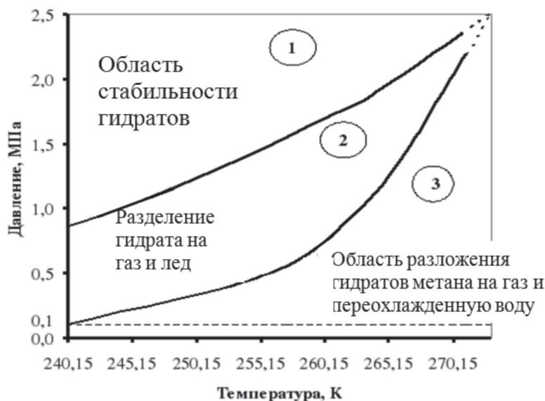
Рис. 1. Области образования и разрушения гидратов газа метана [1]
