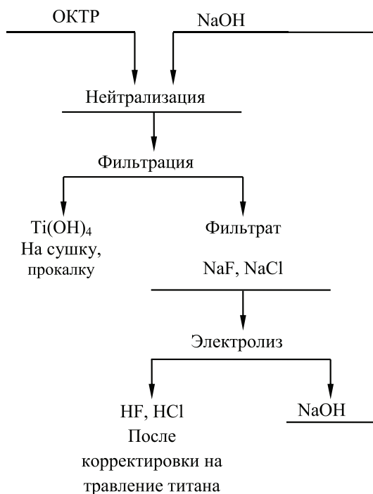
Рис. 5. Технологическая схема переработки ОКТР
