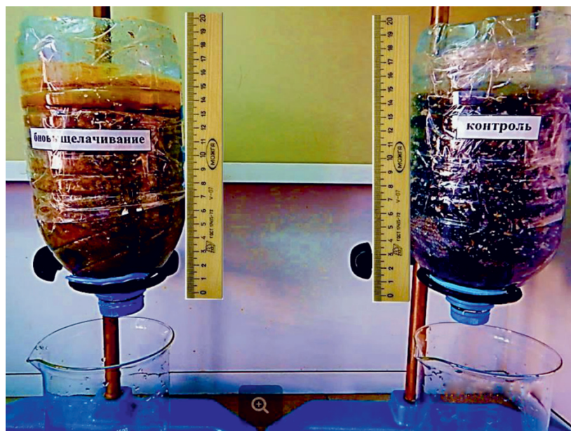
Рис. 1. Тестовая колонна с исходной рудой с классом крупности « -10 + 0,5 мм»
