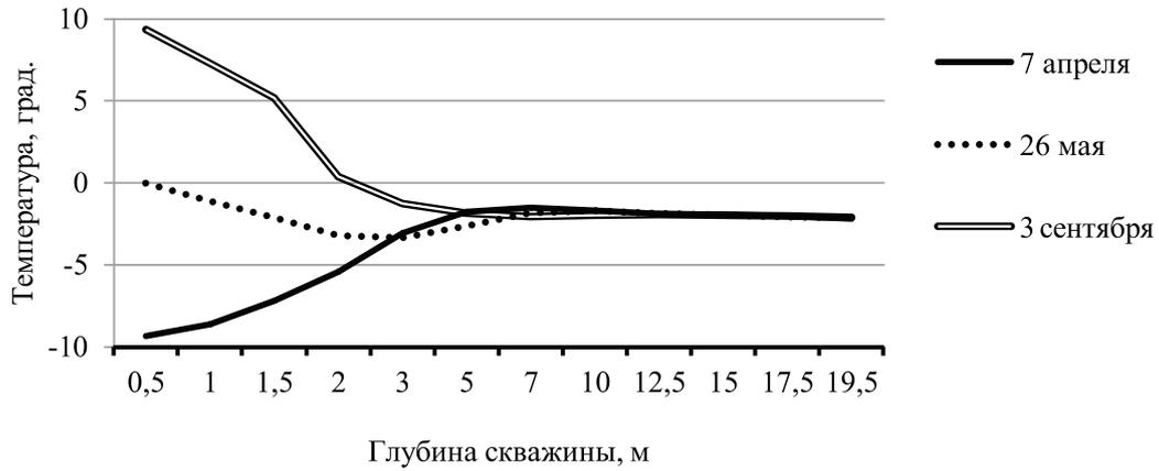
Рис. 1. Температура массива многолетнемерзлых пород по глубине наблюдательной скважины в течение года
