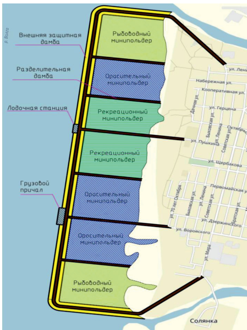
Рис. 4. Конструкция польдера водохранилищного оросительного ур.п. Быково
