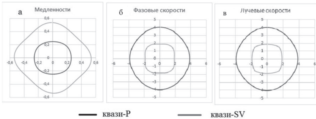
Рис. 1. Индикатрисы медленностей (а), фазовых скоростей (б) и лучевых скоростей (в) монокристалла пресного льда Ih. Черная линия – квазипродольная волна, серая – квазипоперечная волна
