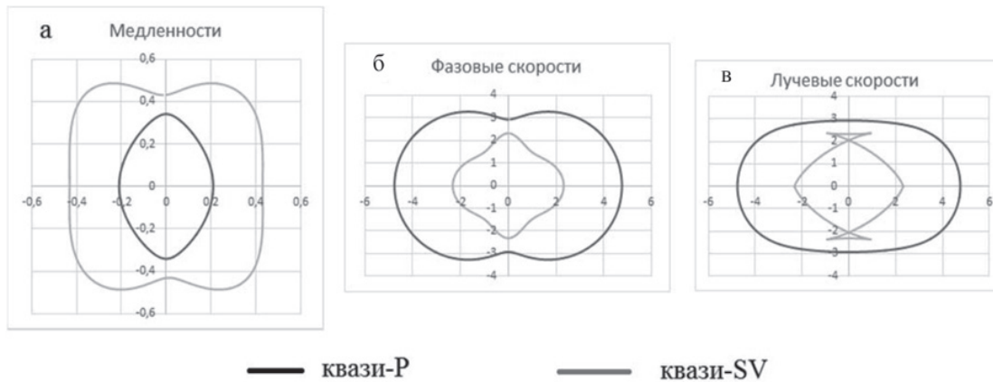
Рис. 2. Индикатрисы медленностей (а), фазовых скоростей (б) и лучевых скоростей (в) монокристалла цинка. Черная линия – квазипродольная волна, серая – квазипоперечная волна
