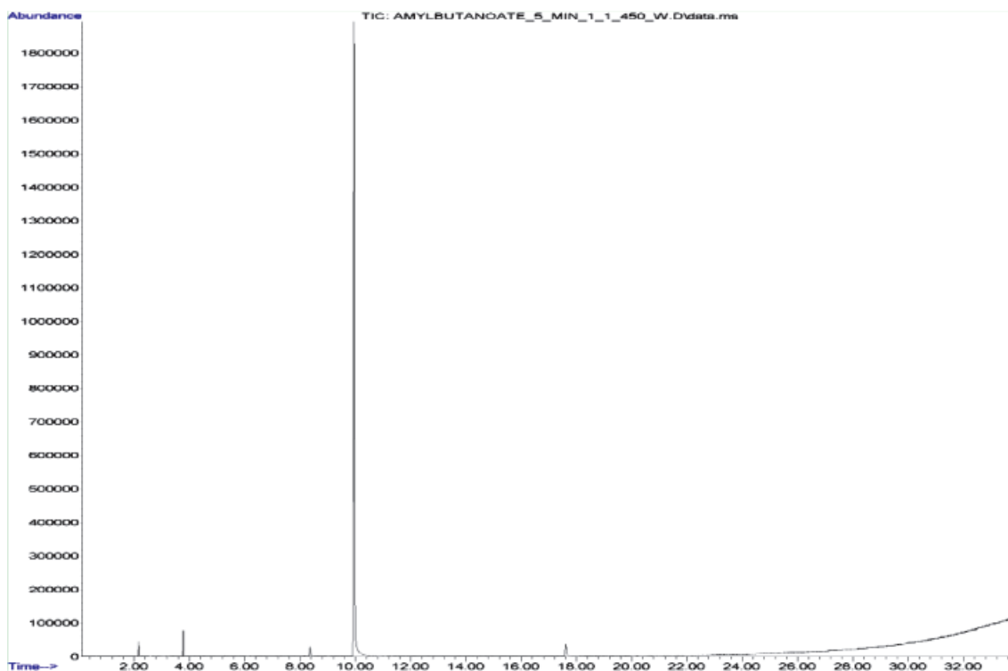
Рис. 1. Хроматограмма н-пентилбуаноата, полученного сверхвысокочастотным облучением
