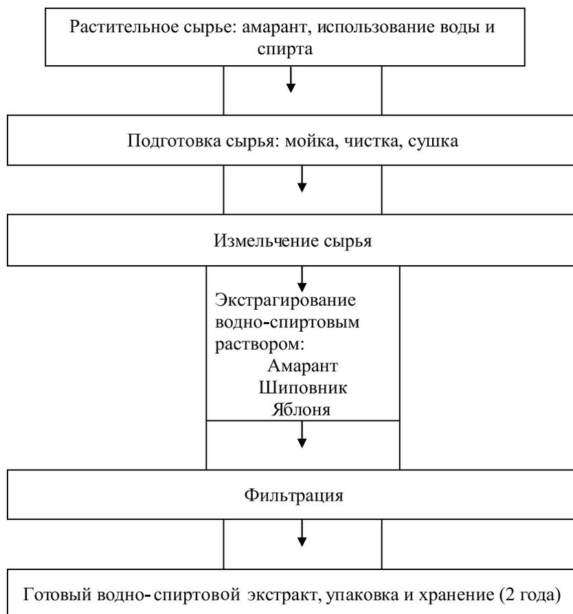
Рис. 2. Принципиально-технологическая схема получения экстрактов
