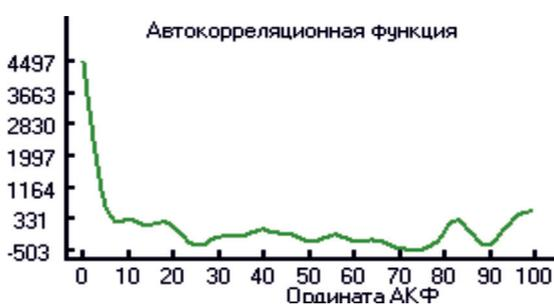
Рис. 8. Расчетные пространственные корреляционные функции яркостных профилей ядра, полученные на второй стадии просачивания нефти
