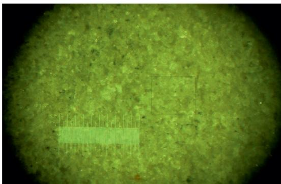
Рис. 1. Изображение рельефа поверхности керна, полученное на начальной стадии просачивания нефти через керновый материал (однократный промежуток времени)
