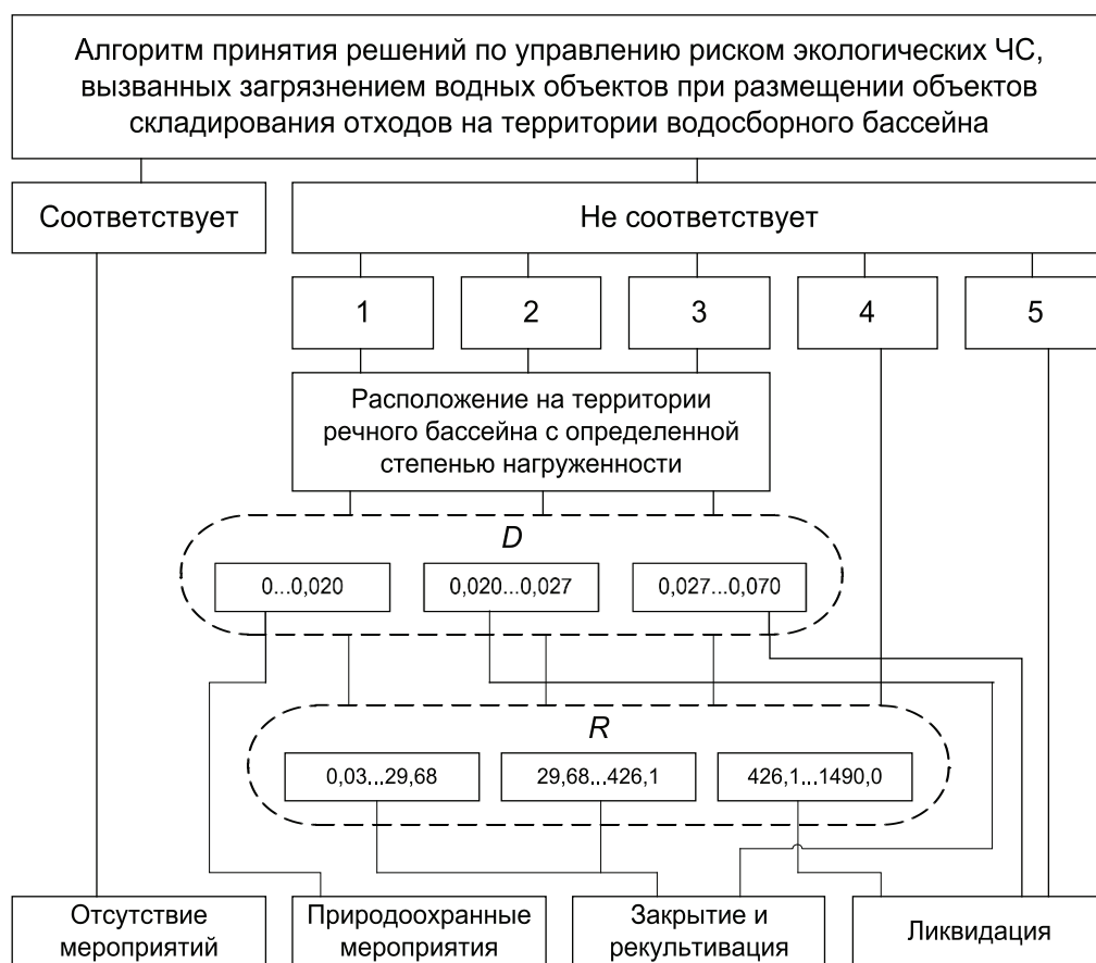
Рис. 3. Схема реализации алгоритма принятия решений при управлении размещением проектируемых и существующих объектов складирования ТБО:
