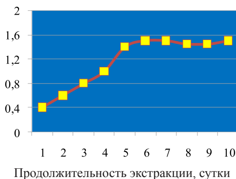
Рис. 2. Динамика извлечения экстрактивных веществ 60%-м этанолом из корней амаранта
