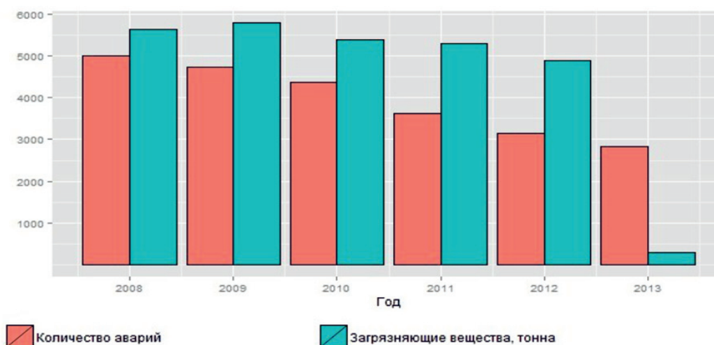
Рис. 1. Аварийность на нефтепромысловых трубопроводах за 2008–2013, ХМАО
