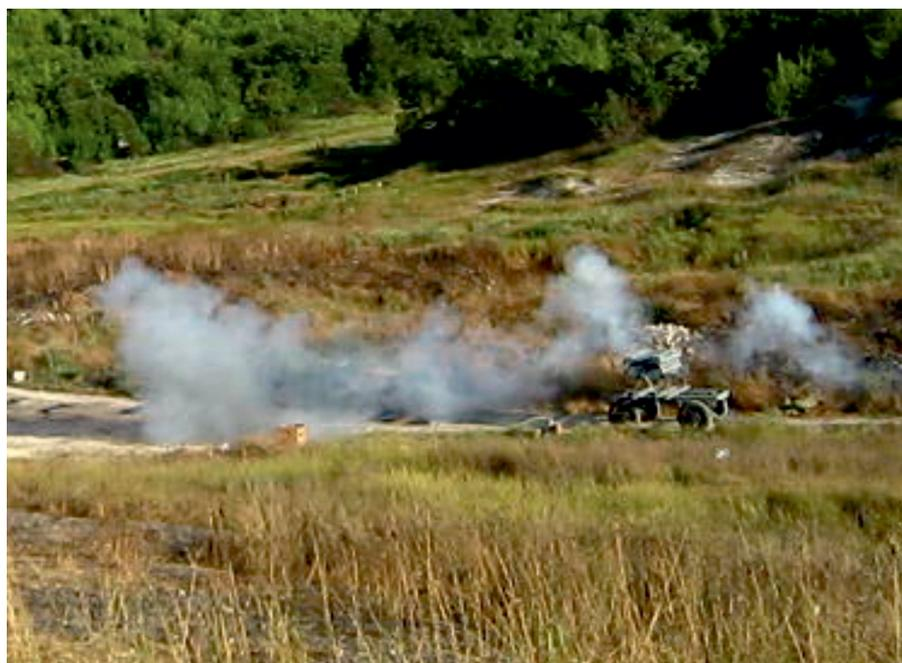
*Рис. 2. Фрагмент залпового распыления 7,5 кг биосорбента залпом из 5 стволов до 55 м, с равномерным покрытием слоем биосорбента площади до 450 м<sup>2</sup>*
