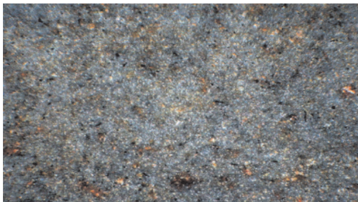
Рис. 2. Микрофотографии (увеличение в 400 раз) осадков гидроксида магния
