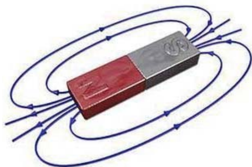
Рис. 1. Магнит и силовые линии магнитного поля
