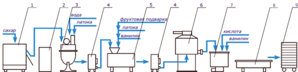
Рис. Технологическая схема производства восточных сладостей
