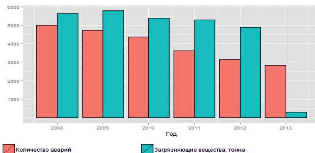
Рис. 1. Аварийность на нефтепромысловых трубопроводах за 2008–2013, ХМАО
