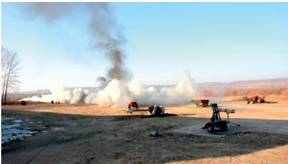
Рис. 3. Распыление 200 кг мелкодисперсного порошка на дальность до 240 м, площадь накрытия до 2500 кв.м
