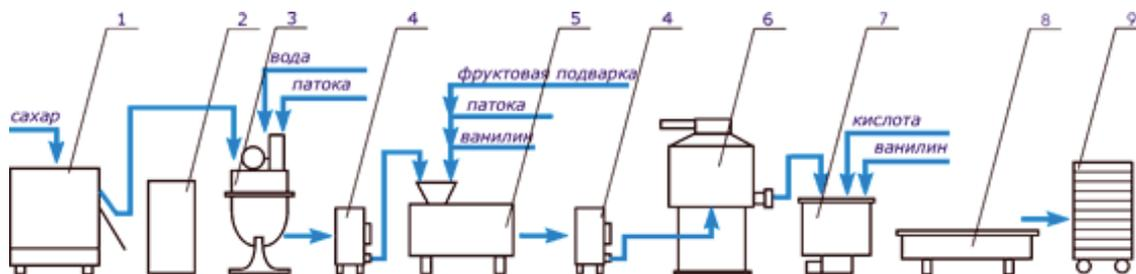
Рис. Технологическая схема производства восточных сладостей
