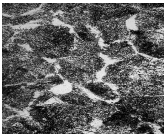
Рис. 1. Структура горячекатаного проката стали марки 40X – перлит + феррит, \times 500
