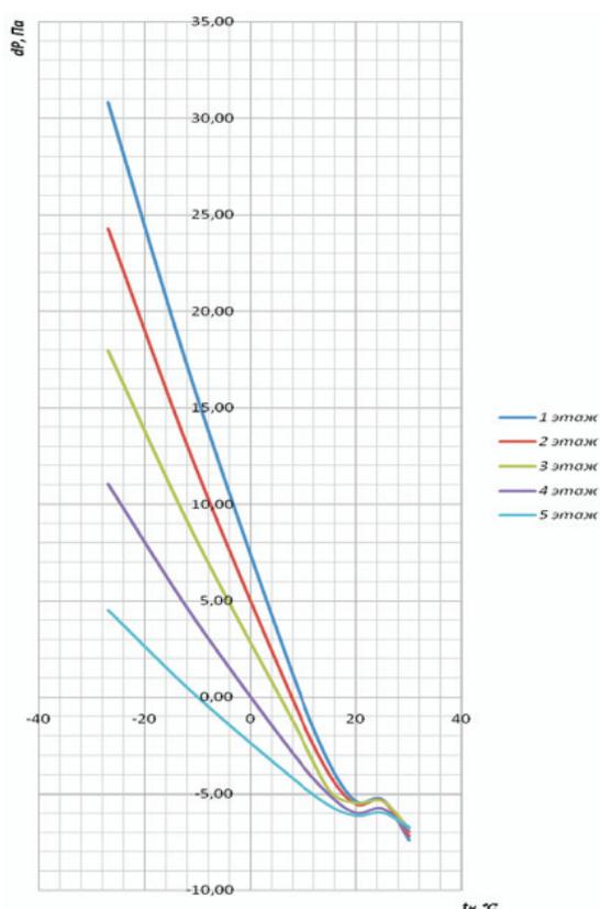
Рис. 2. Зависимость требуемых перепадов давления от температуры наружного воздуха по этажам
