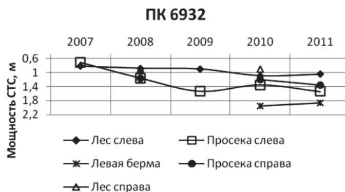
Динамика глубины протаивания грунтов в районе ПК 6932
