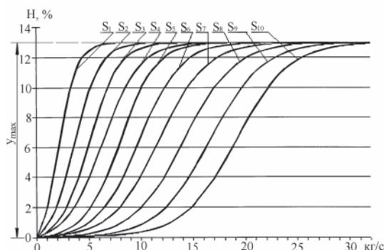
Рис. 1. Потери зерна от подачи при различных рабочих зазорах
