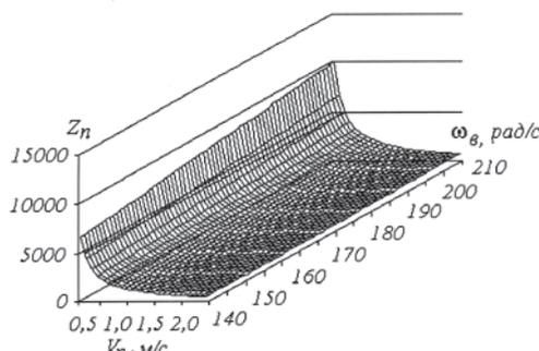
Аналогично ранее полученным графическим зависимостям просчитаны число ударов вальцов барабана в рабочем зазоре в той же последовательности и исходных параметров.
